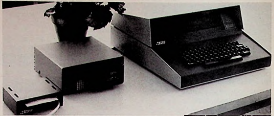
Das Text-Übermittlungs-System „Model 2002 Teleprinter“. Rechts das Terminal, in der Mitte der Decoder und links der Thermodrucker
